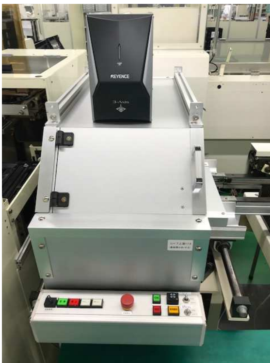
レーザーマーカ-制御架台
