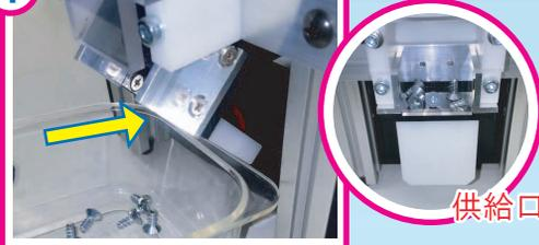
取出しレバーを奥へ押しあてると、ねじが供給口から落ちてきます。
